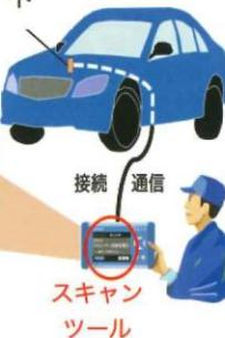
「スキャンツール」をOBDポートに接続し、「OBD」が記録している、各種装置の故障の有無や作動状況を読み出すことで、装置が正常に作動しているかを点検します（いわゆるOBD点検）。
